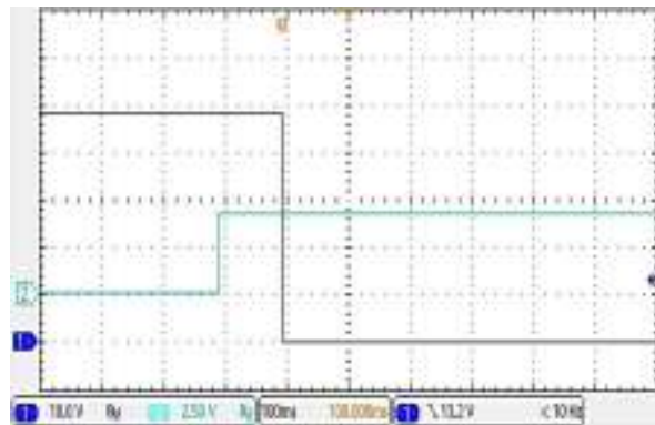
图(8):遥控端使能关机,输出电压下降波形 (CH1:Vout,CH2:ON/OFF 电压,输出端满载)
