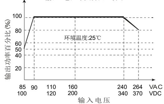
注:①对于输入电压为85~100VAC/240~264VAC/100~120VDC/340~370VDC需在温度降额的基础上进行输入电压降额;
