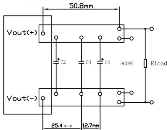
图 (16) 输出纹波与噪声测试示意图
