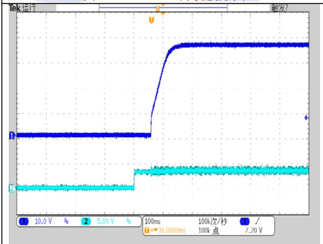
图 (9) 25%-50%-25% (2.5A/μs) 动态波形图
