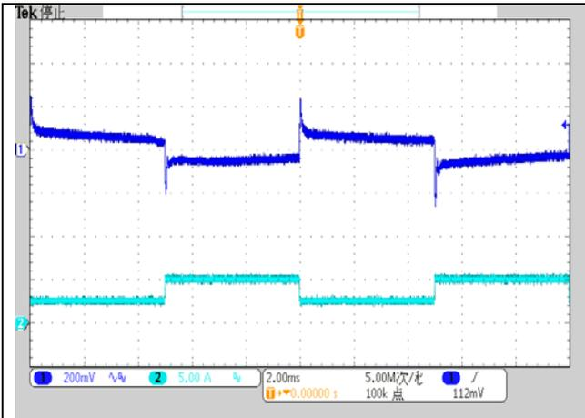
CH1: 输出电压波形 (200mV/div)
