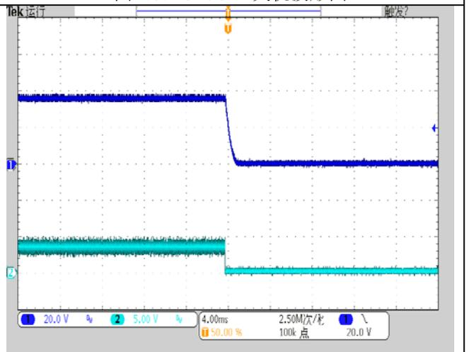
图 (10) 50%-75%-50% (2.5A/μs) 动态波形图
