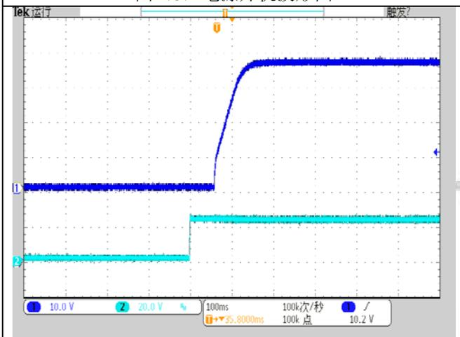
图 (7) ON/OFF开机波形图
