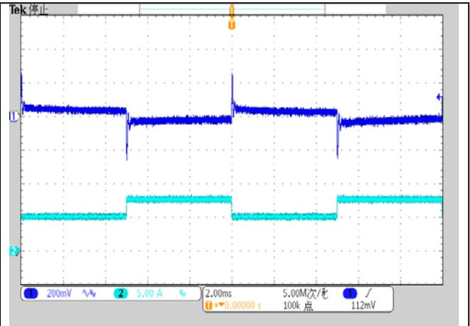
CH1: 输出电压波形 (200mV/div)
