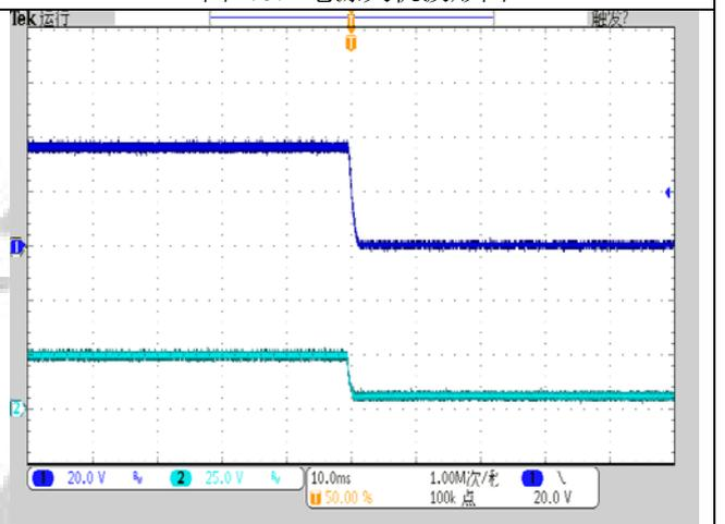
图 (8) ON/OFF关机波形图
