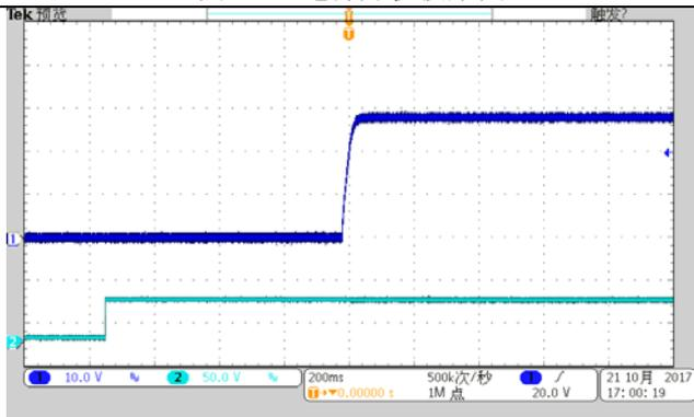
CH1: 输出电压波形 (10.0V/div)
