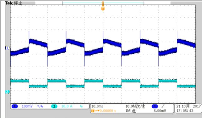
CH1: 输出电压波形 (100mV/div)
