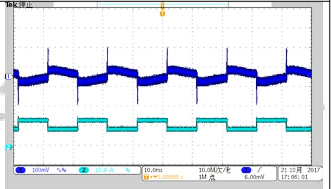
CH1: 输出电压波形 (100mV/div)
