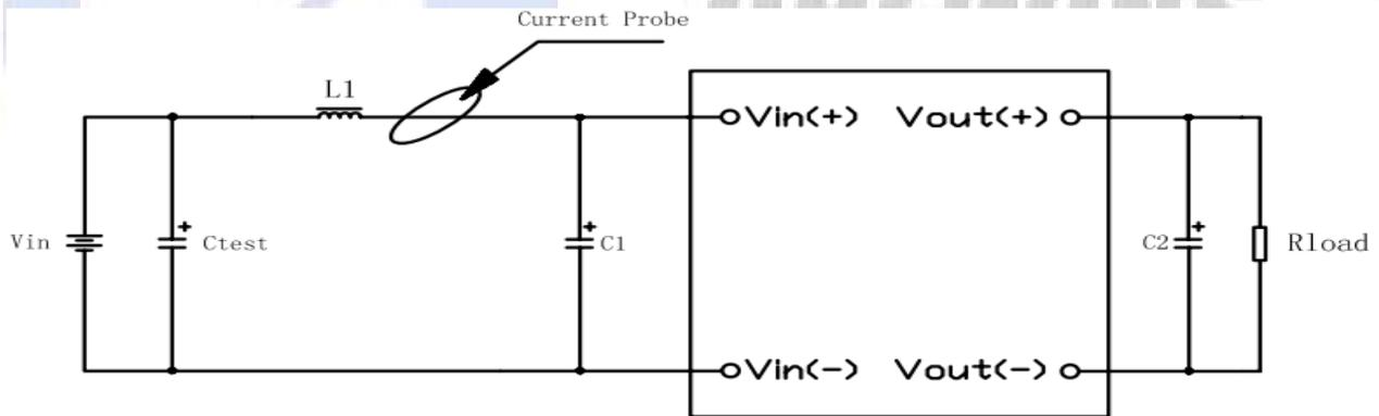
图 (15) 输入反射纹波电流测试示意图
