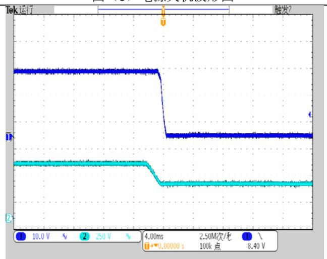
CH1: 输出电压波形 (10V/div)
