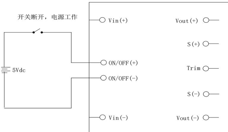
图（14）遥控端控制方式示意图
