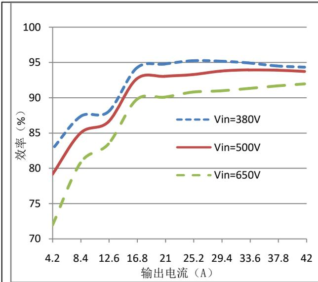
图 (3) 输入特性曲线图 (Tc=25°C)
