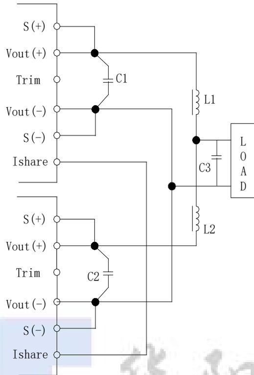
图 (20) 多路输出并联示意图
