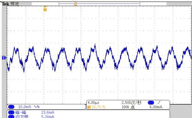
图 (12) 输出纹波电压波形图
