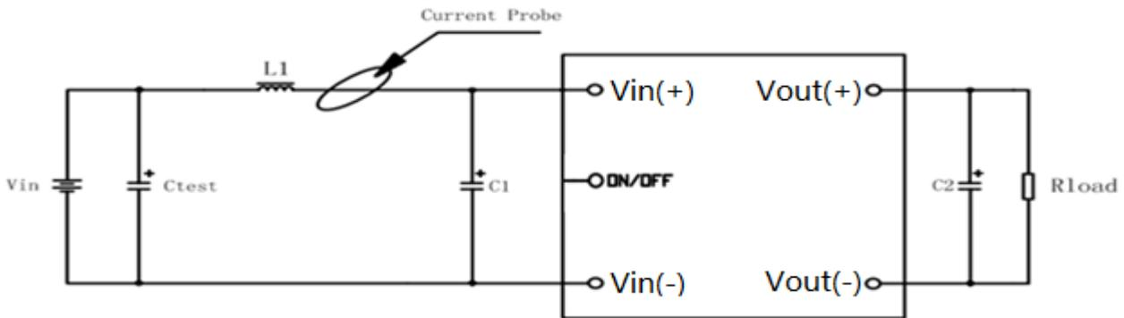
图 (15) 输入反射纹波电流测试示意图
