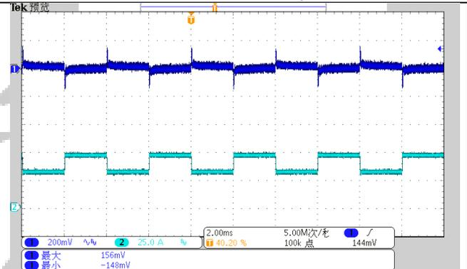
CH1: 输出电压波形 (200mV/div)
