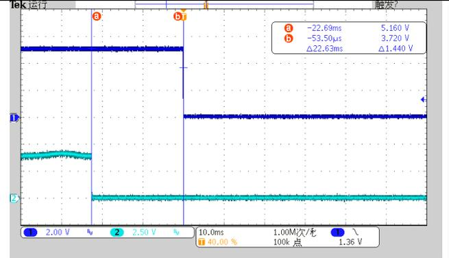
CH1: 输出电压波形 (2.0V/div)
