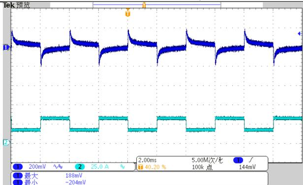
CH1: 输出电压波形 (200mV/div)
